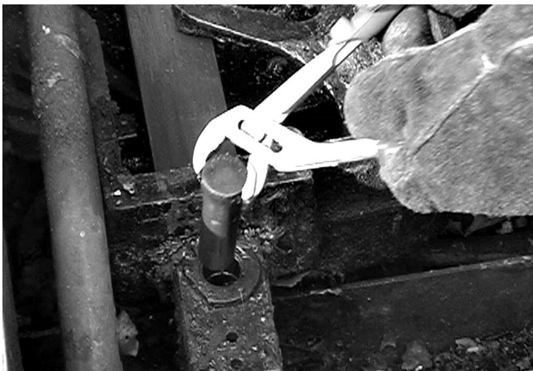
Vyjmutí spojovacího čepu
