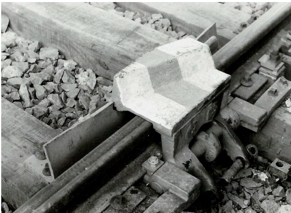
Výkolejka vypnutá z ústředního přestavování
