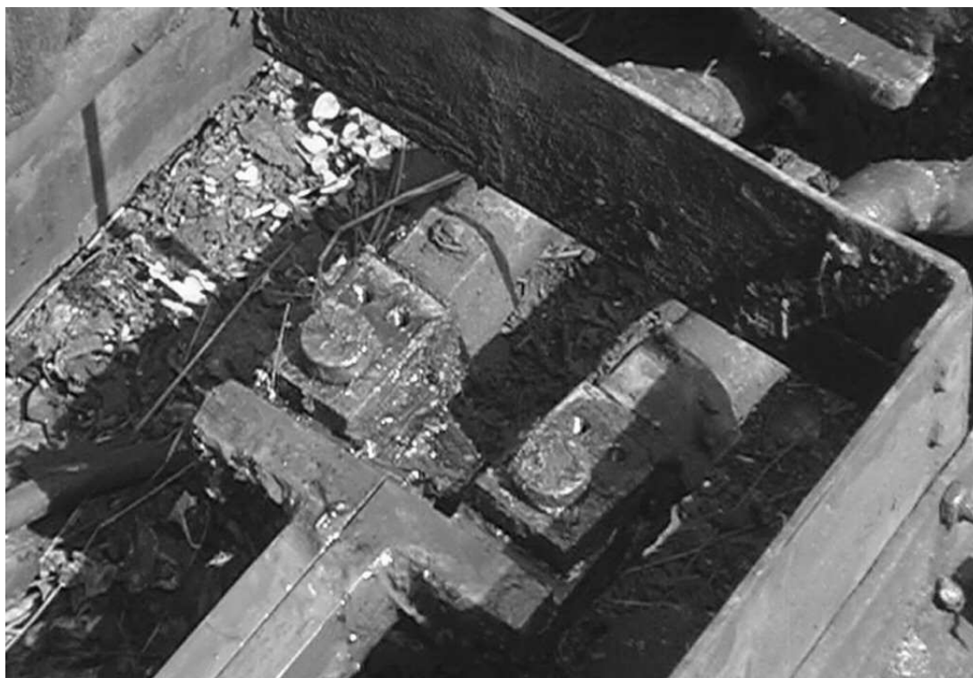
Připojení závorníkových spojnic před vyjmutím spojovacích čepů
