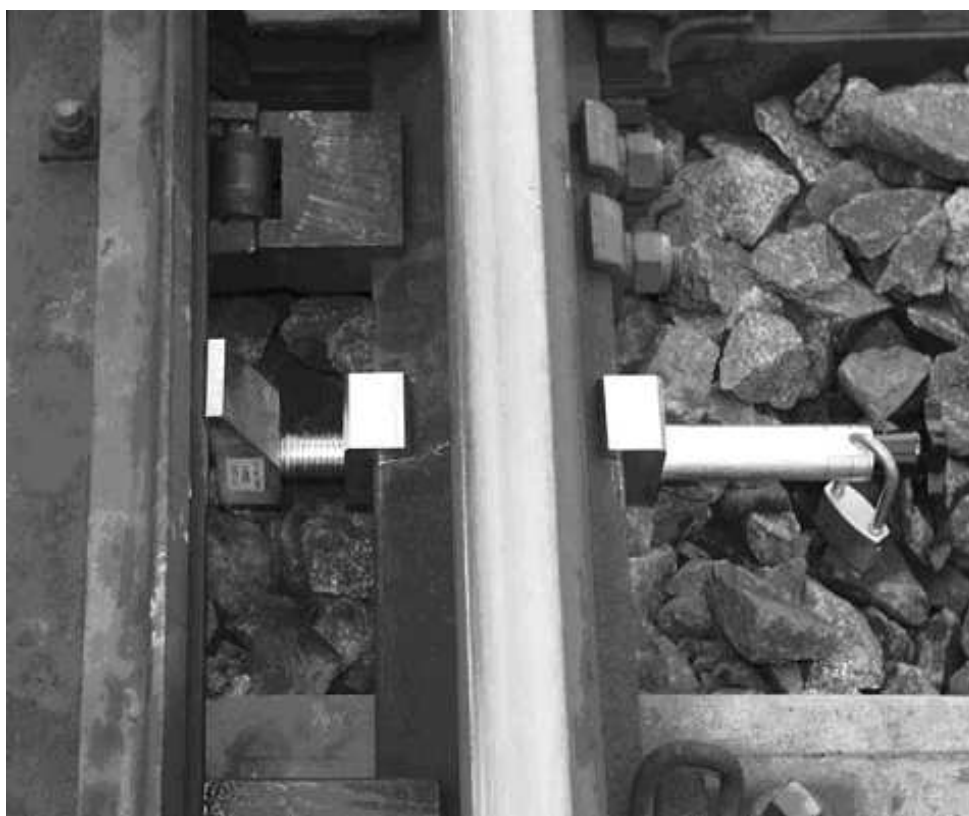
Přenosný odtlačný zámek v zajišťovací poloze
