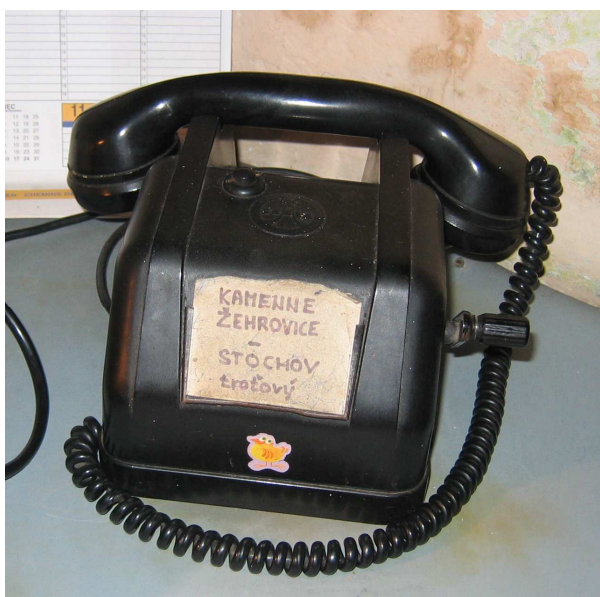
Telefonní přístroj MB pro hláskové spojení s tlačítkem s evidencí obsluhy pro nouzové udělení telefonické odhlásky
