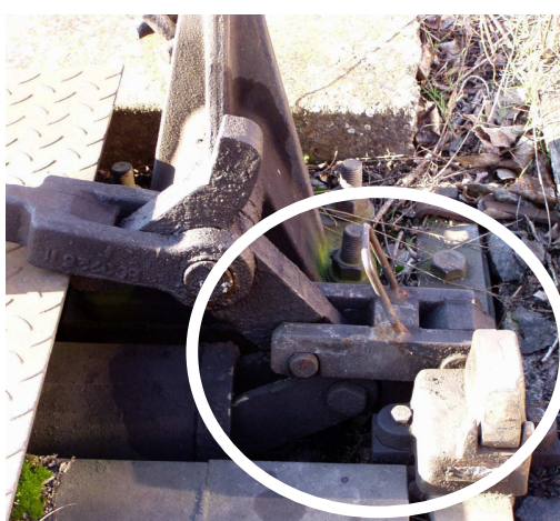
Samovratný přestavník (zapnutý do samovratné činnosti)
