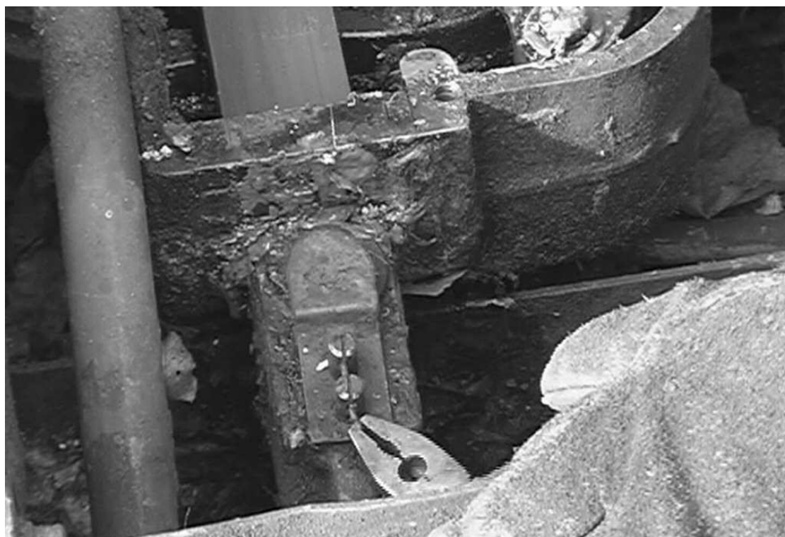
Sejmutí plomby na drátu a vytažení závlačky
