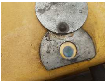
Obrázek 28 – Clonka na horní části elektrického přestavníku
