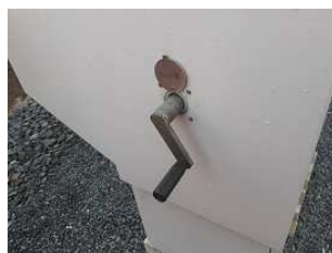
Obrázek 37 – Vložená klika pro přestavení výhybky s hydraulickým přestavníkem nouzově ručním způsobem
