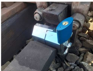
Obrázek 16 – Uzamčení PZČZ visacím zámekem (uzamykatelným otvorem směrem nahoru, např. z důvodu nedostatku místa)
