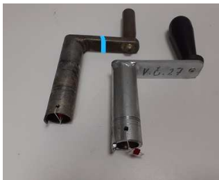
Obrázek 26 – Klika k přestavování hydraulického přestavníku (vlevo) a klika k přestavování elektrického přestavníku (vpravo)
