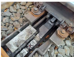
Obrázek 8 – Vybrání závorovacího pravítka s nominální hodnotou 6 cm, pro zajištění výhybky PZČZ
