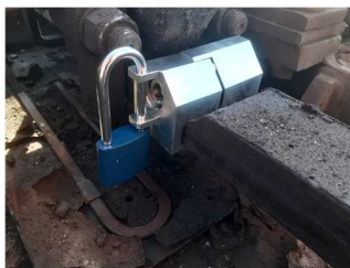
Obrázek 15 – Uzamčení PZČZ visacím zámekem (uzamykatelným otvorem směrem dolů)
