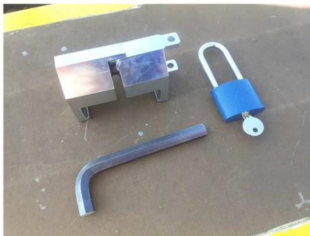
Obrázek 6 - Přenosný zámek čelistového závěru, inbus klíč a visací zámek
