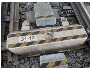
Obrázek 32 – První hydraulický přestavník výměny se závěrovými zámky
