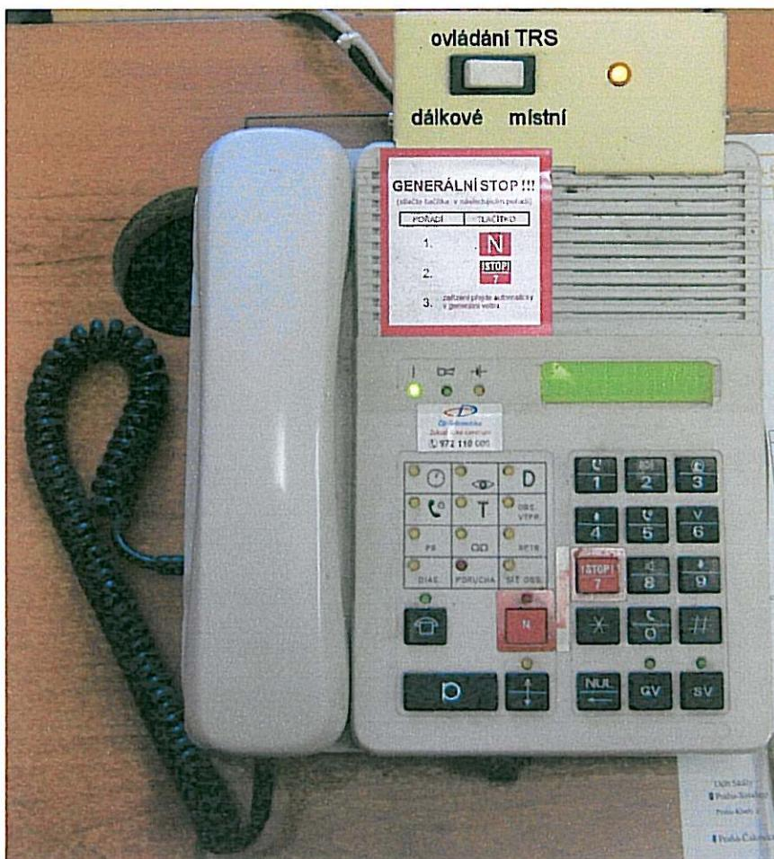
Toto zařízení je připevněno na horní hraně stávající ovládací skříňky TRS VO 47. Na straně ovládané části ZR 47 se skládá z přepínače a žlutého indikačního světla. V základním stavu svítí žluté indikační světlo a ovládací skříňku TRS VO 47 lze ovládat. Po přepnutí přepínače na ovládané ZR 47 žluté indikační světlo zhasne a ovládání se tak přepne na nadřízenou dopravnu. Zařízení TRS VO 47 v ovládané dopravně se vypne a pak z tohoto pracoviště již TRS nelze ovládat.
