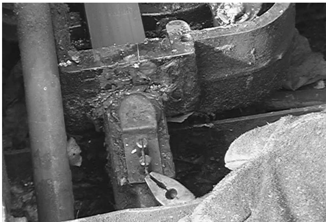
Sejmutí plomby na drátu a vytažení závlačky
