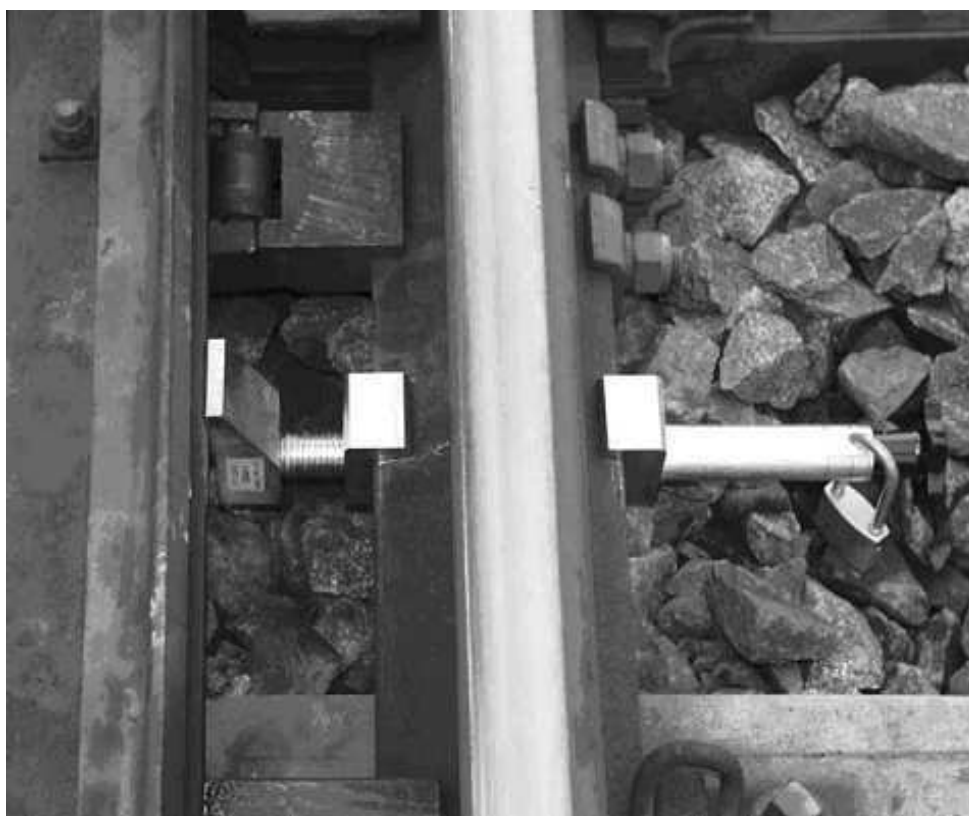
Přenosný odtlačný zámek v zajišťovací poloze
