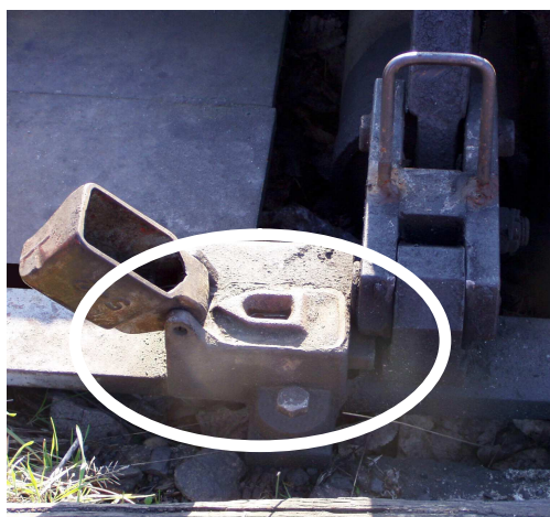
Samovratný přestavník (zapnutý do samovratné činnosti)
