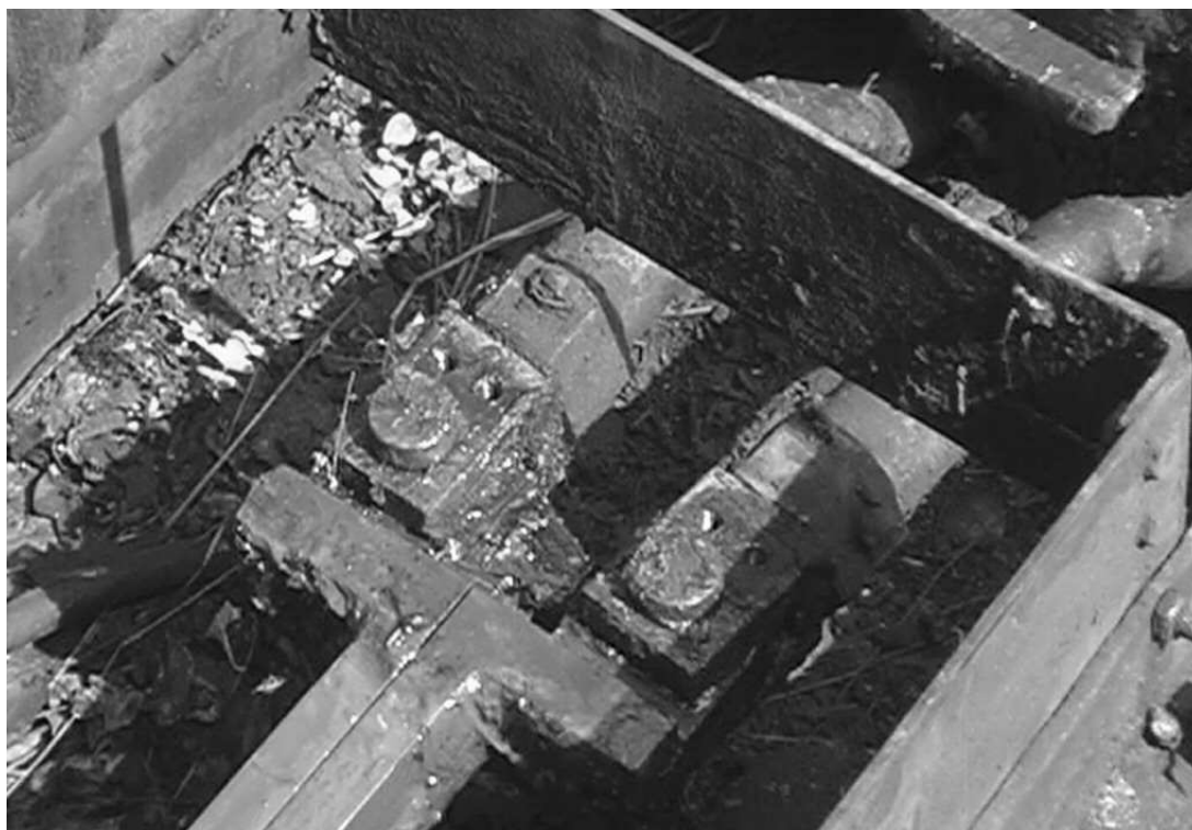
Připojení záporníkových spojnic před vyjmutím spojovacích čepů
