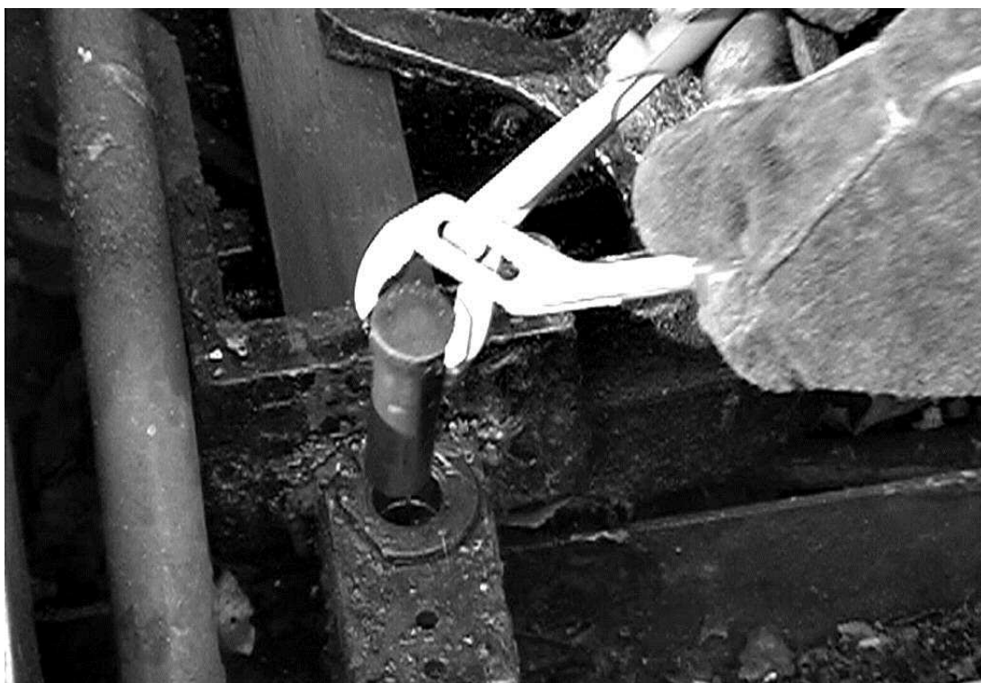
Vyjmutí spojovacího čepu
