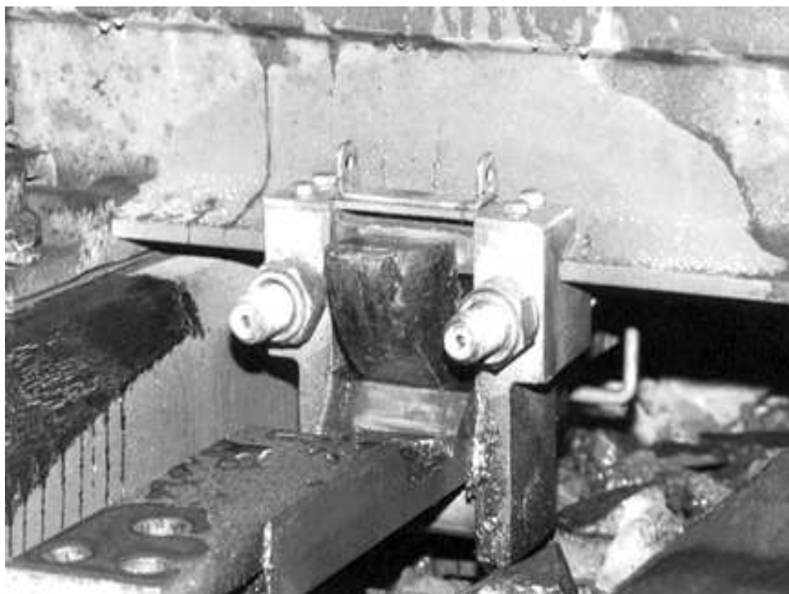
Čelistový závěr - nominální podepření závěrového háku
