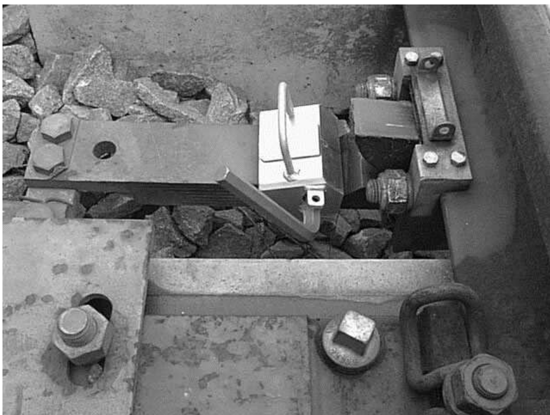
Přenosný zámek čelistového závěru
