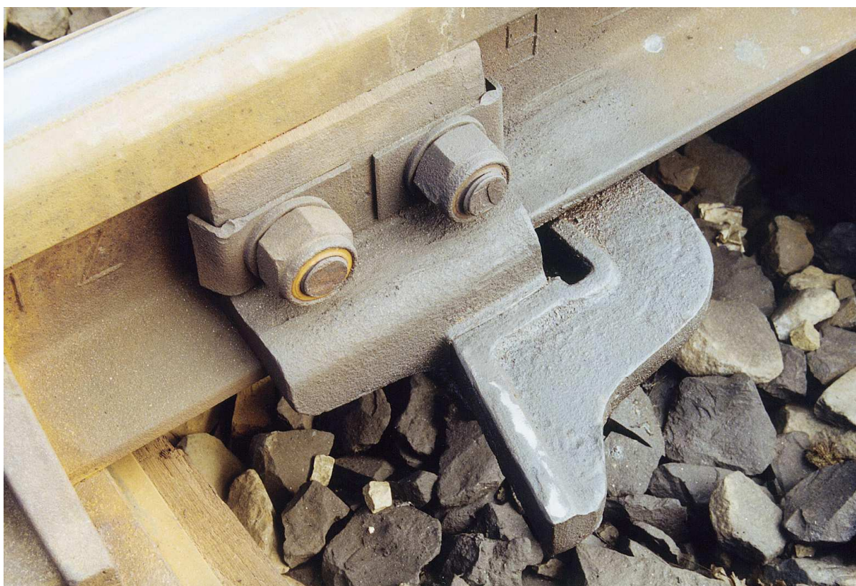
Hákový závěr – úplné zaklesnutí závěrového háku
