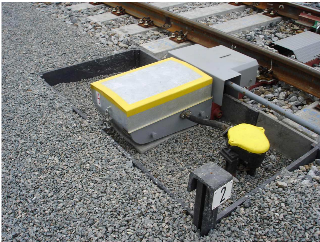
Přírubový žlabový pražec s přírubovým elektrickým přestavníkem
