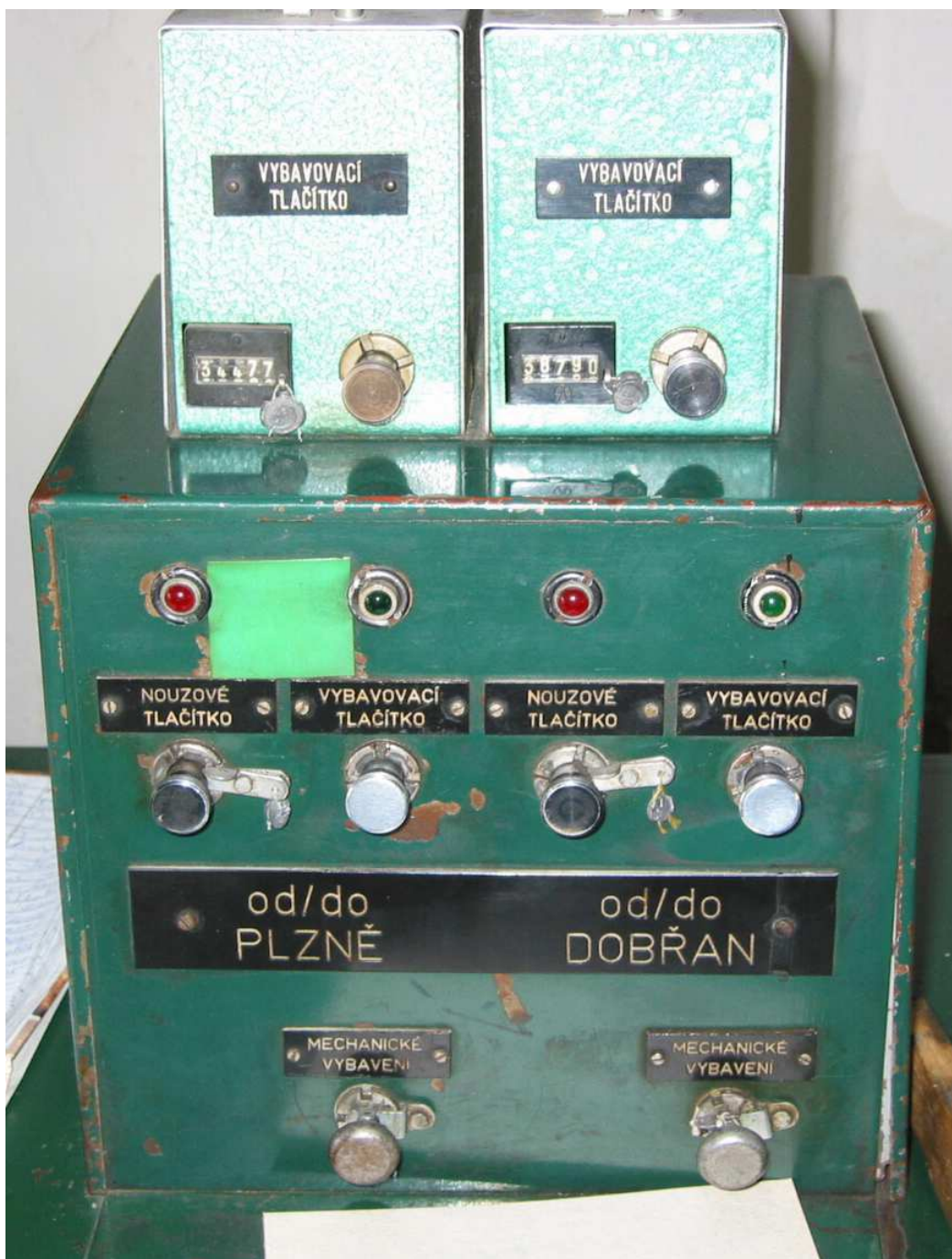
Samočinný závěr výměn – reléový vybavovač
