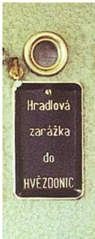
Hradlová zarážka s nouzovým vybavovacím zařízením na výhybkářském přístroji
