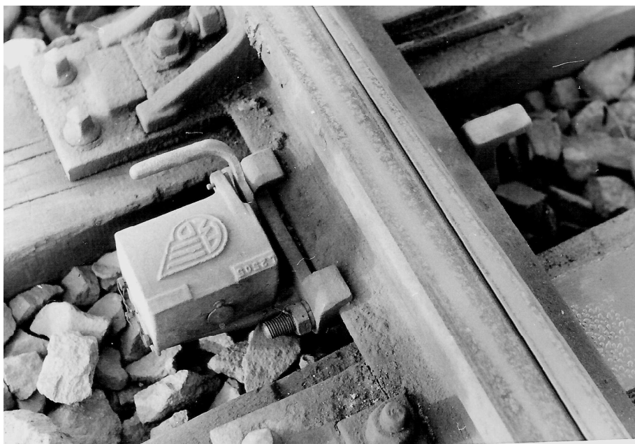
Uzamčený výměnový zámek bez ochranné skříňky
