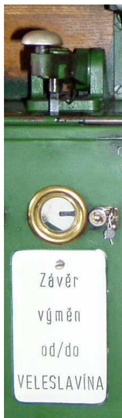
Výměnové hradlo s nouzovým vybavovacím zařízením
