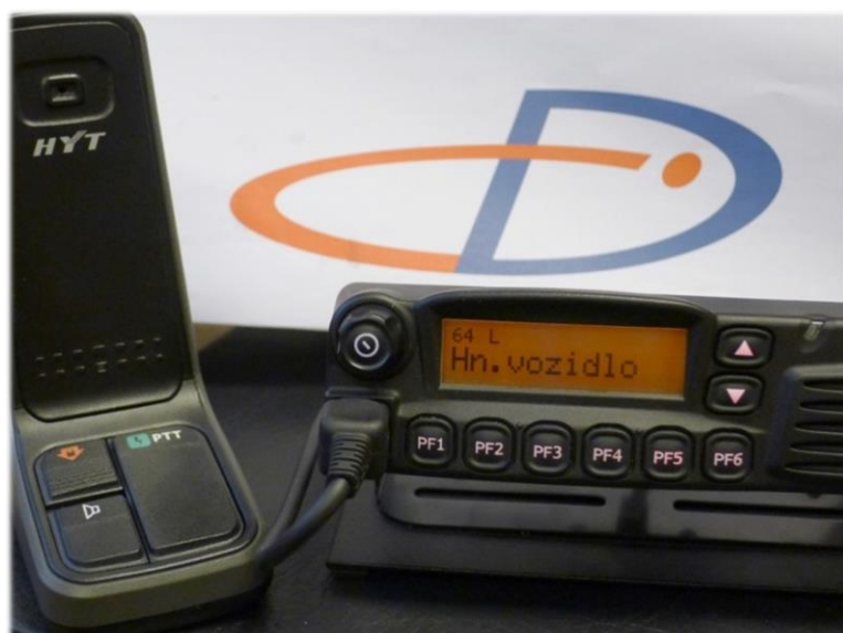
Obr. 8: Radiostanice TM-800 při příjmu selektivní volby odeslané z radiostanice hnacího vozidla
