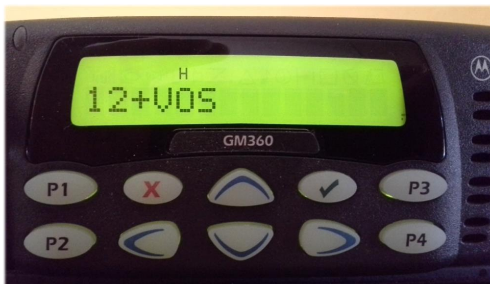
Obr. 2: Displej radiostanice GM360 se zvoleným „novým“ kanálem VOS (označeným 12+VOS) – „12“ je číslo kanálu, „+“ (plus) označuje „nový“ kanál s kanálovým rastrem 12,5 kHz, „VOS“ je označení rádiové sítě
