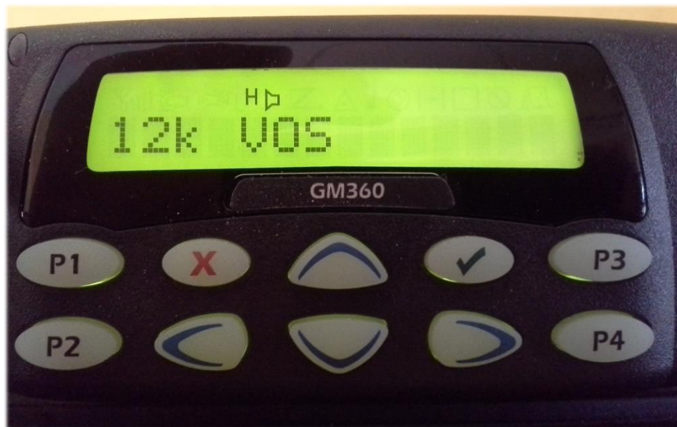
Obr. 1: Displej radiostanice GM360 se zvoleným „starým“ kanálem VOS (označeným 12k VOS)
