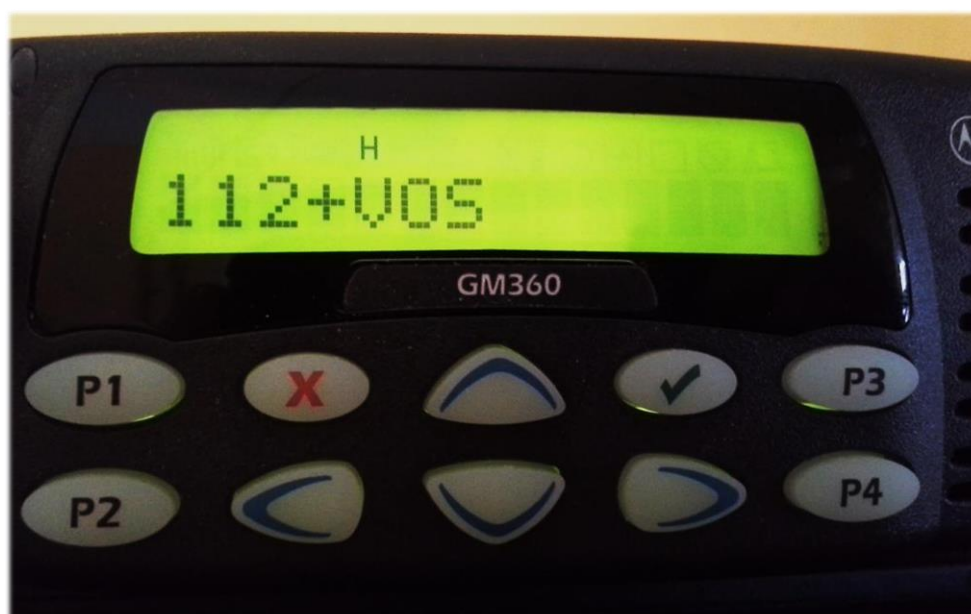
Obr. 9: Displej lokálního ovládání radiostanice GM360 v systému Radiovoice se zvoleným „novým“ kanálem VOS (označeným 112+VOS) – „1“ je předčíslí, „12“ je číslo kanálu, „+“ (plus) označuje „nový“ kanál s kanálovým rastrem 12,5 kHz, „VOS“ je označení rádiové sítě
