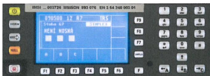
4. Obsluha zahájí pomocí tlačítka F1, F2 a F3 postupné vložení příslušné tří písmenné kombinace adresy (selektivní volba) volané základnové radiostanice
