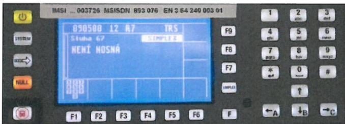
11. Obsluha vozidlové rdst. po zahájení komunikace ze strany stacionární rdst. komunikuje po zaklíčování tlačítkem PTT (mikrotelefon).
