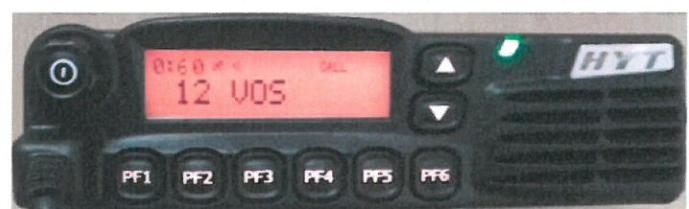
**13.**Po uvolnění tlačítka PTT, při klíčování ze strany volající rdst., zhasne indikační dioda a znova se spustí odečet do ukončení spojení (60->0).
