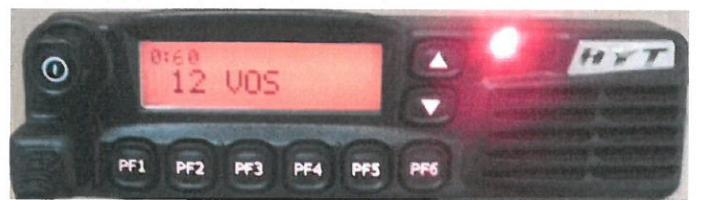
10. Po uvolnění tlačítka PTT na lokálním ovládání zhasne indikační dioda a znova se spustí odečet do ukončení spojení (60->0).
