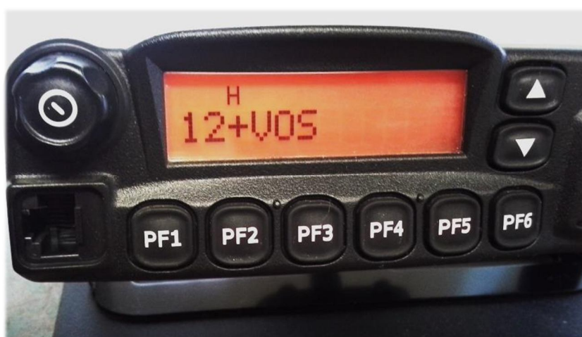
Obr. 6: Displej radiostanice TM-800 se zvoleným „novým“ kanálem VOS (označeným 12+VOS) – „12“ je číslo kanálu, „+“ (plus) označuje „nový“ kanál s kanálovým rastrem 12,5 kHz, „VOS“ je označení rádiové sítě
