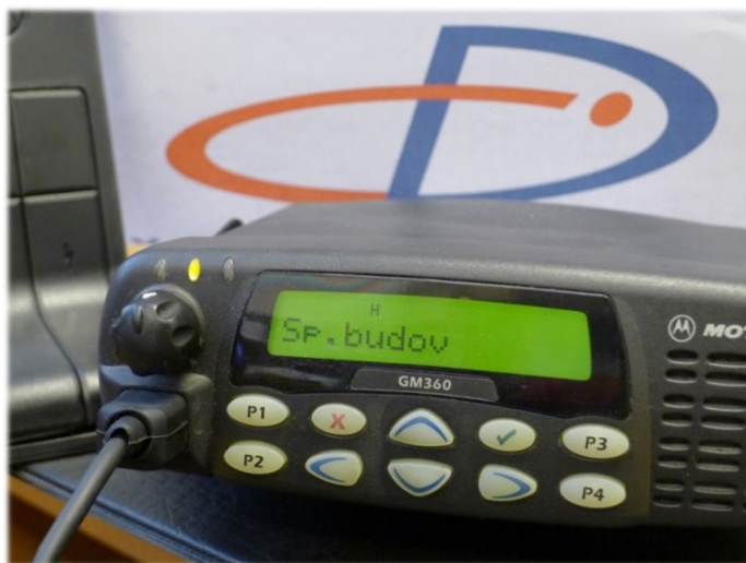
Obr. 4: Radiostanice GM360 při příjmu selektivní volby, odeslané z radiostanice Správy budov
