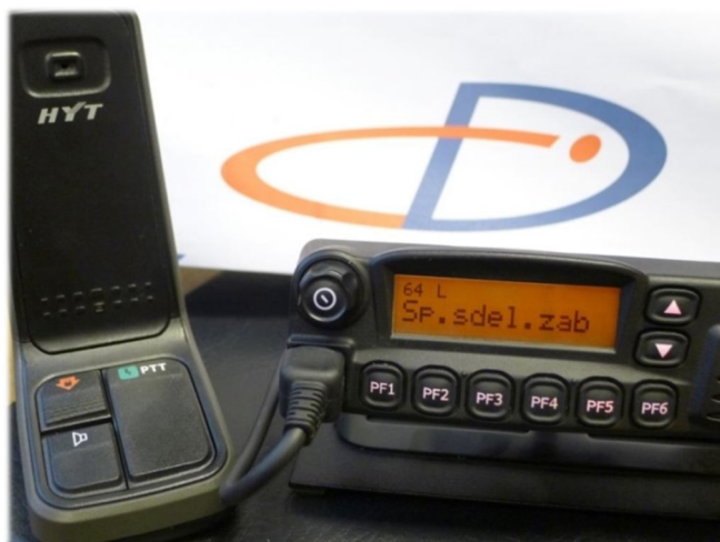
Obr. 7: Radiostanice TM-800 při příjmu selektivní volby odeslané z radiostanice Správy sdělovacího a zabezpečovacího zařízení
