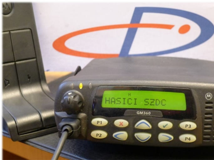
Obr. 3: Radiostanice GM360 při příjmu selektivní volby odeslané z radiostanice HSZ SZDC
